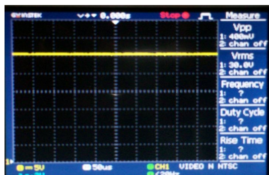
Fig.19. DC Voltage Output
