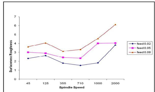
Fig 2 (d) – 10mm φ Drill and different Feed Rates
