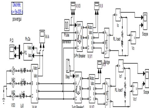
Fig 7 Dynamic Diode Rectifier Load
